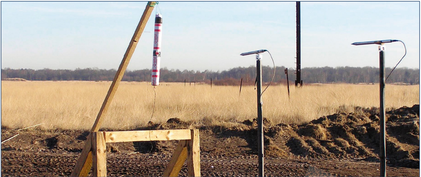
图1：“铅笔型”探针通常安装在来自爆炸源的多个位置。
