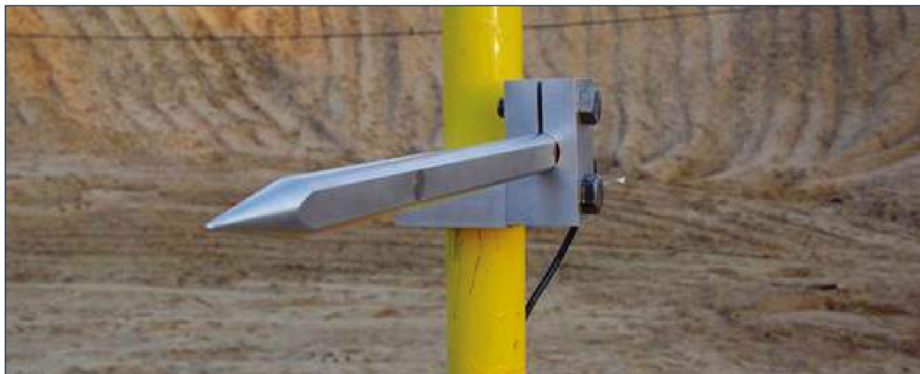
图2: “铅笔型”探针的典型安装。
