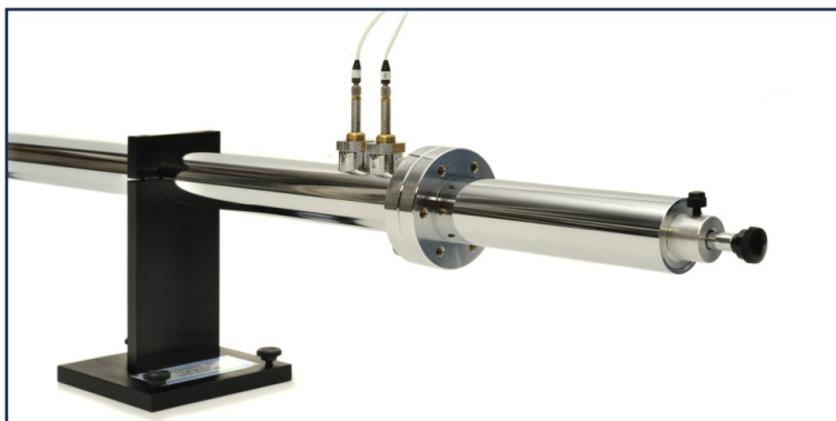
在阻抗管上嵌入式安装压力场传声器进行测量
