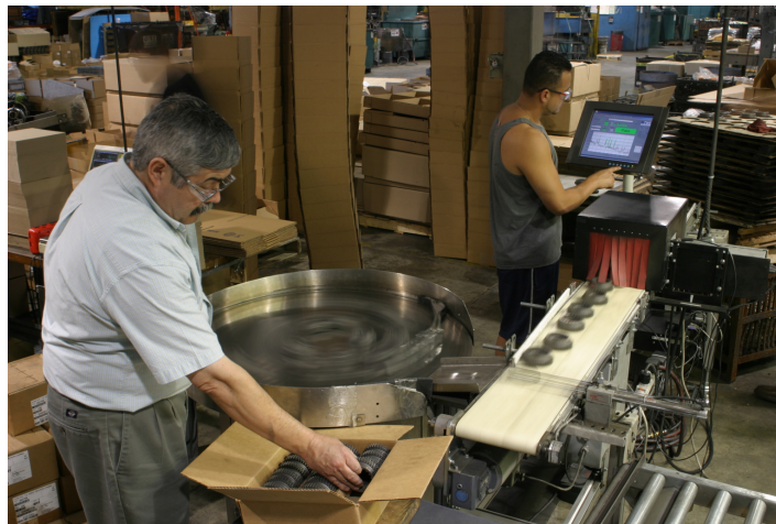
图三.工厂全自动化系统，使用音盒来测试零件.
